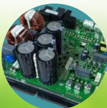
Unidad de inversor
